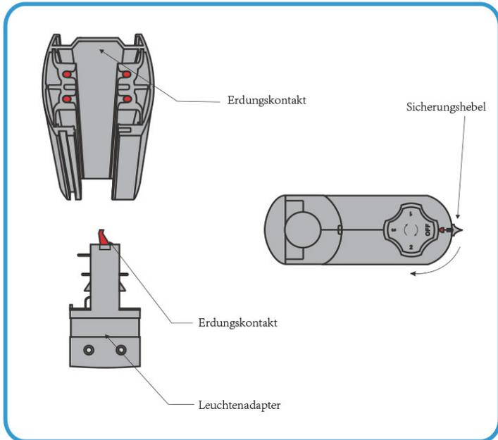
Schritt 2: Setzen Sie die Leuchte direkt im Schienensystem ein. Stellen Sie den mechanischen Sicherungshebel des Adapters nach rechts, um die Leuchte mechanisch in der Schiene zu sichern.
